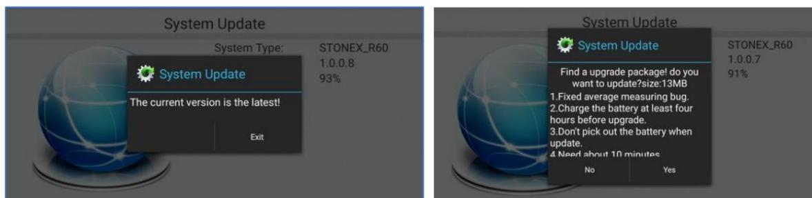
Nach dem automatischen Neustart des Instruments wird die folgende Meldung angezeigt. Klicken Sie auf JA, um die alte FW-Datei aus dem Cache-Speicher des Instruments zu entfernen.
