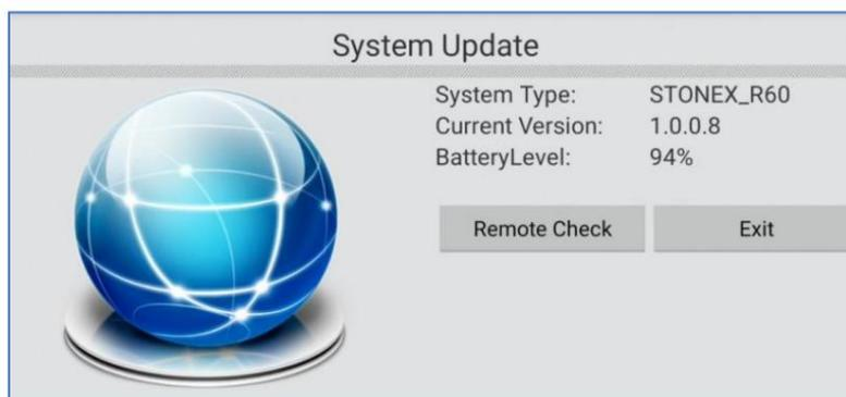
In dieser Anwendung ist es möglich, die aktuelle FW-Version (im Beispiel oben 1.0.0.8) zu lesen, den Batteriestand zu überprüfen (im Beispiel oben 94 %) und das Vorhandensein eines FW-Updates zu prüfen.
