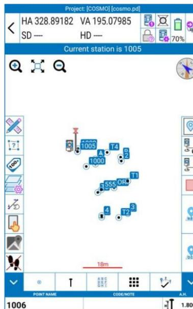
Die *DIS*- und *REC*- Symbole sind rot, wenn die Station noch nicht deklariert wurde. Mit Cube-a können Sie keine Punkte vermessen, solange die Tasten rot bleiben. Wenn Sie jedoch auf eine davon drücken, wird die folgende Meldung angezeigt, die direkt zur Stationsdefinitionsseite führt. Klicken Sie auf **OK**, um die Station zu deklarieren (siehe [10.1 Station auf Punkt](#) und [10.2 Resektion/Freie Station](#)).
