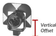
In diesem Abschnitt kann der Benutzer auch den Poltyp auswählen und zwischen *GPS-Pol* (vertikaler Versatz des Prismas berücksichtigen) und *TS-Pol* (vertikaler Versatz des Prismas nicht berücksichtigen) wählen.
